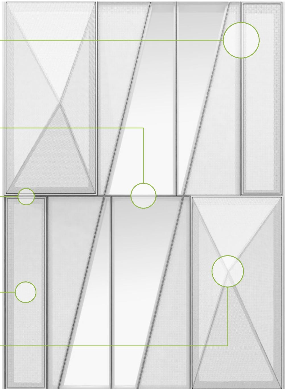
**Schüco Elementfassade mit verdeckt liegenden Öffnungsflügeln und mikroperforierten Lisenen (Konzept)**
