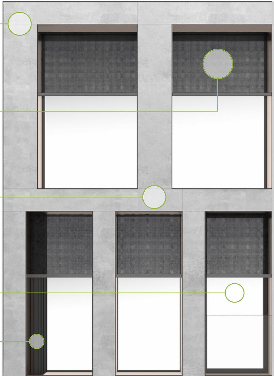
**Schüco Elementfassade mit integrierter Schiebetür, Lüftungssystem mit Luftreinigungsfunktion und schallabsorbierenden Fassadenelementen (Konzept)**
