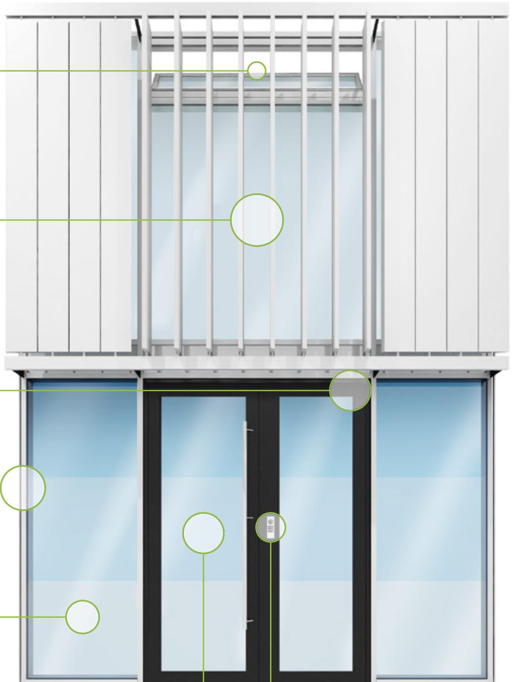
**Schüco Seamless – Panorama Design Fassadenelement mit integrierten Öffnungselementen, Sonnenschutz und vernetzten Kontrollelementen**
